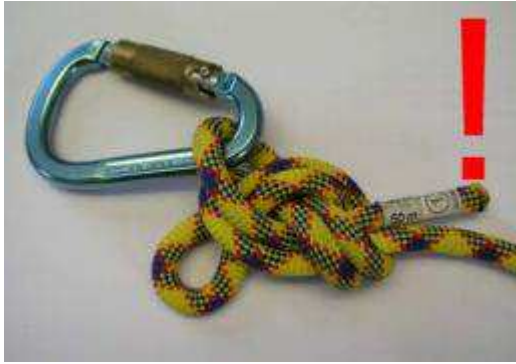
Afbeelding 2: een voorgeknoopte achtknoop heeft zich iets losgewerkt. Hierdoor is er een touwlus ontstaan waar de karabiner per ongeluk in gehangen kan worden. Bron: DAV Sicherheitsforschung.
